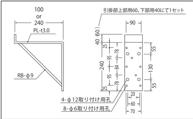
■カバー専用足 詳細図 取り付け穴ピッチ
