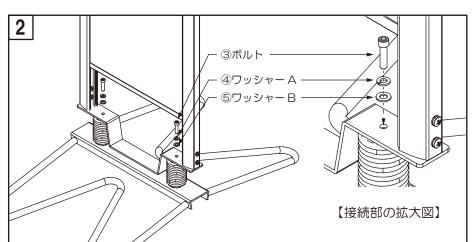
図の様に、①表示部枠と②ベースフレームの接続部に③-④-⑤の順で 2 箇所にビスと各種ワッシャーを手で回 しいれます。
