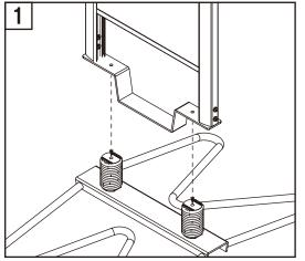
まず、①表示部枠を②ベースフレームのスプリングの上に穴位 置を合わせながら乗せます。揺れて倒れないよう、乗せたあと は必ず手で支えてください。
