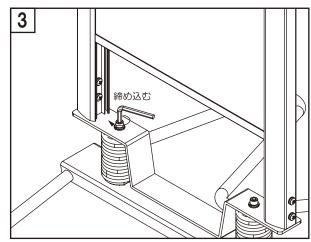
最後に、⑥組み立て用レンチで必ず、2 箇所ともしっかりと締め込んで ください。風を逃す反発部ですので、入念に確認をお願いします。
